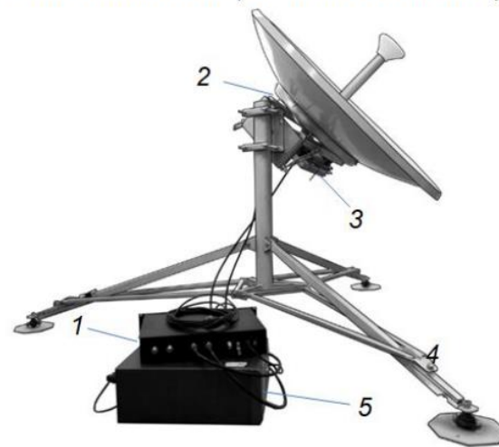
Рис. 1. Малогабаритна ТРРС: 1 - модемний пристрій; 2 - антенно-поворотний пристрій; 3 - блок приймально-передавальний; 4 - бухта кабелів; 5 - блок живлення
