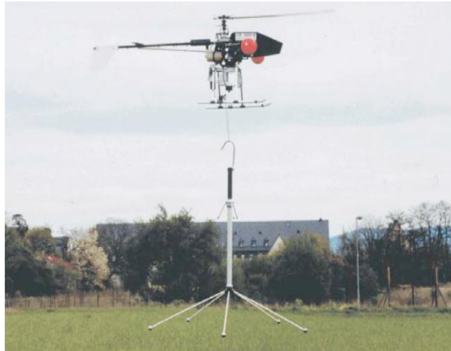
Рис. 1. Приклад розміщення сенсорів за допомогою БПЛА
