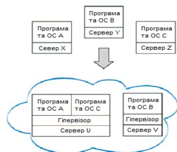
Рис. 2. Віртуалізація та використання ресурсів
