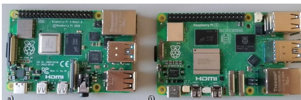
Рисунок 1. Мікрокомп'ютери Raspberry Pi 4B (a) і Raspberry Pi 5 (б).
