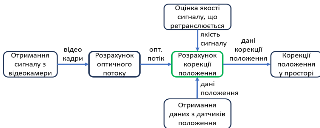
Рис. 2. Метод корекції положення у просторі пристрою, що ретранслює сигнал.
