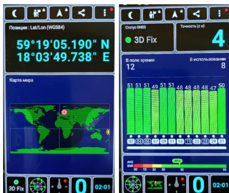
Рис.4. Результати тестування приймачів сигналів ГНСС GPS: а) U-blox; б) Motorola.
