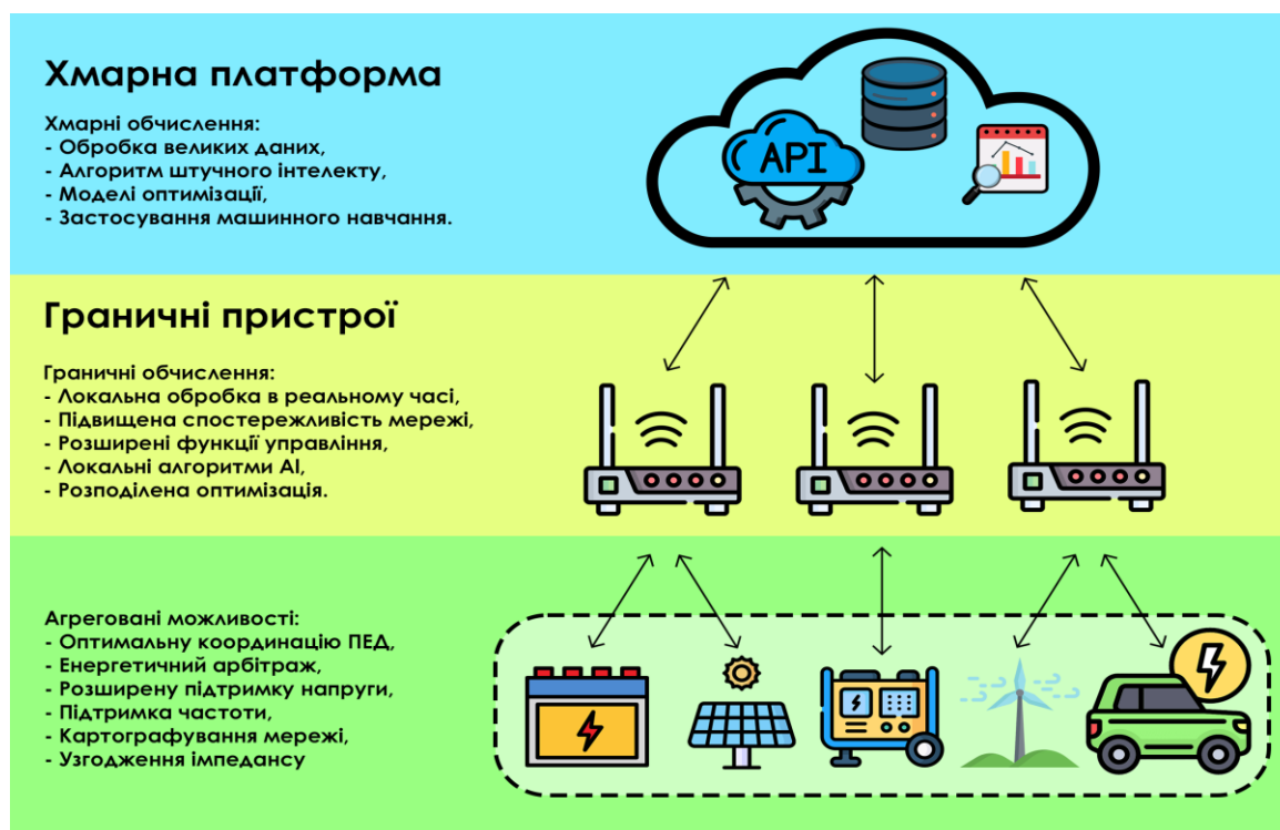
Рис. 1. Схематичне представлення системи (Edge Computing).
