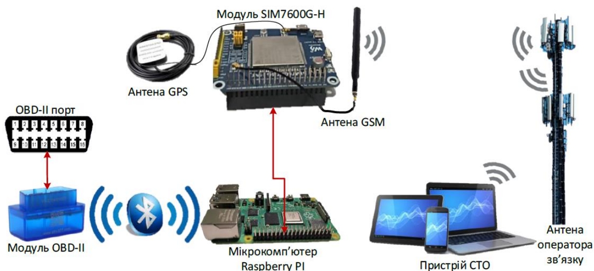
Рис. 1. Схема роботи пристрою віддаленої діагностики автомобіля.
