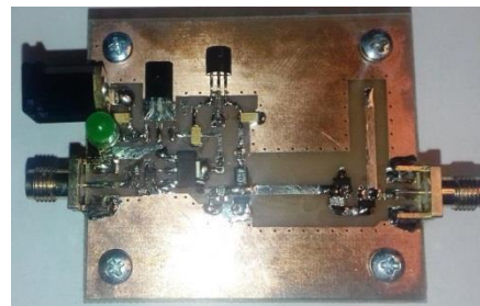
Макет для експериментального дослідження передавання імпульсних надширокосмугових сигналів через прийомопередавач терагерцового діапазону
