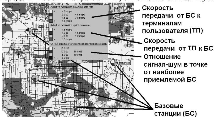
Рис.1 — Проектируемый участок сети с цветовым соответствием покрытия и его параметров
