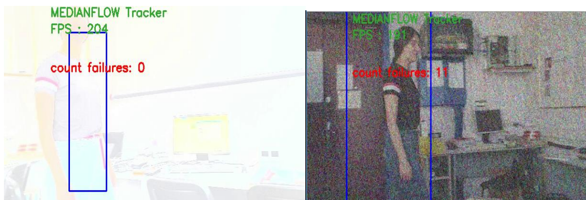
Рис. 2. Результати роботи MedianFlow при збільшеній освітленості кадру та при збільшеному рівні шумів у кадрі відповідно.
