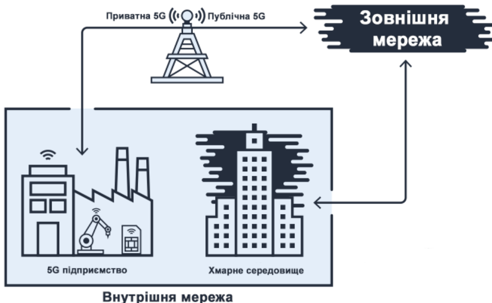
Рис. 1. Непублічна 5G мережа. Закрита мережа підприємства підключена до глобальної 5G-мережі через публічні канали.
