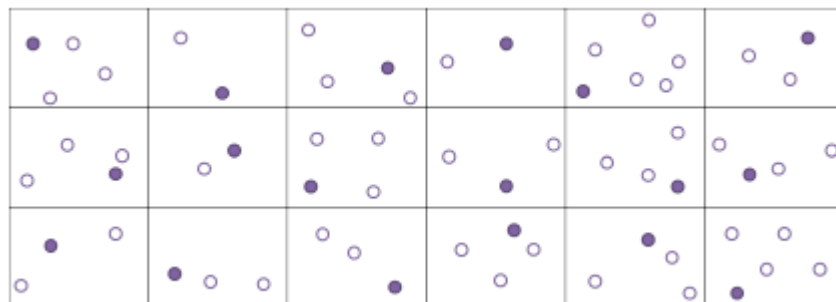
Рис. 1. Приклад методу контролю топології який застосовуються в мережі. Для покриття повного поля , датчик повинен бути активним в кожній області мережі.
