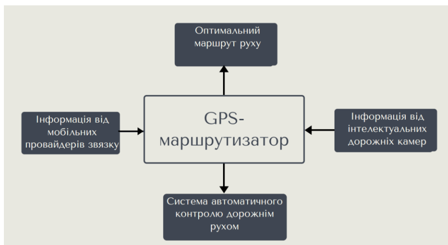
Рис. 3. Принципова схема роботи GPS-маршрутизатора.
