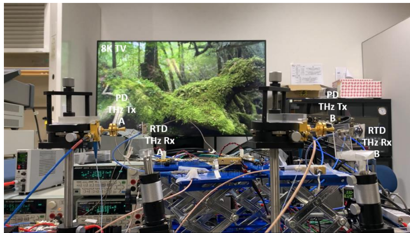
Рис. 4. Фотографія прототипу системи бездротового передавання відео 8K UHD у реальному часі: на передньому плані показані два фотодіодні передавачі (Tx) та два RTD-приймачі (Rx) з телевізійним екраном 8K на задньому плані.
