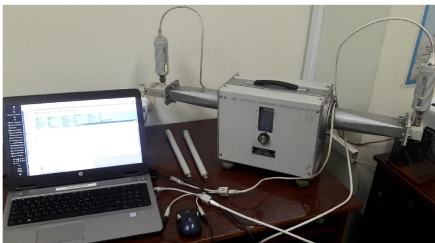
Рис. 2. Валидация результатов метода в лабораторных условиях на базе оборудования 802.11n производителя Mikrotik и аттенюатора ДЗ-28.
